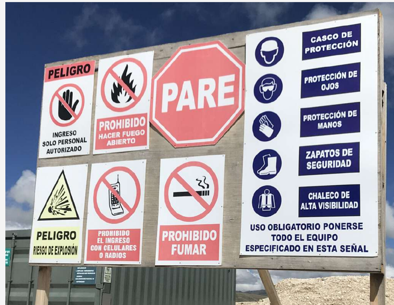
Cartel de seguridad y uso obligatorio de EPPs en el polvorín de la Cantera.
