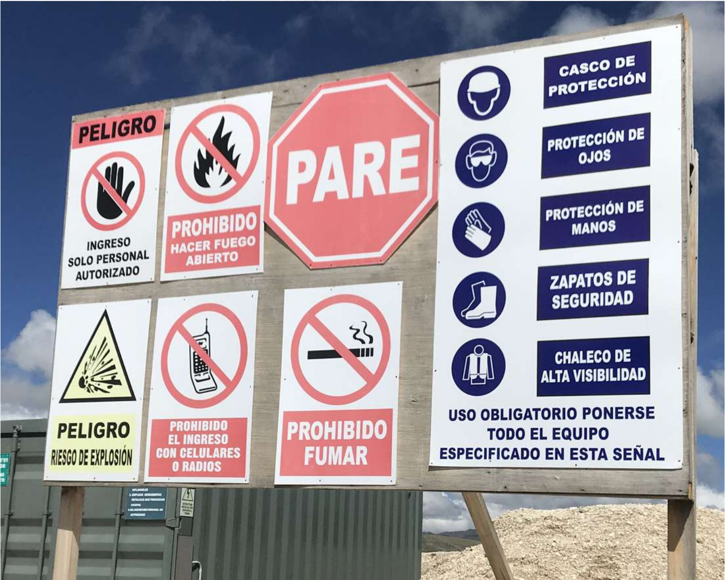
Cartel de seguridad y uso obligatorio de EPPs en el polvorín de la Cantera.
